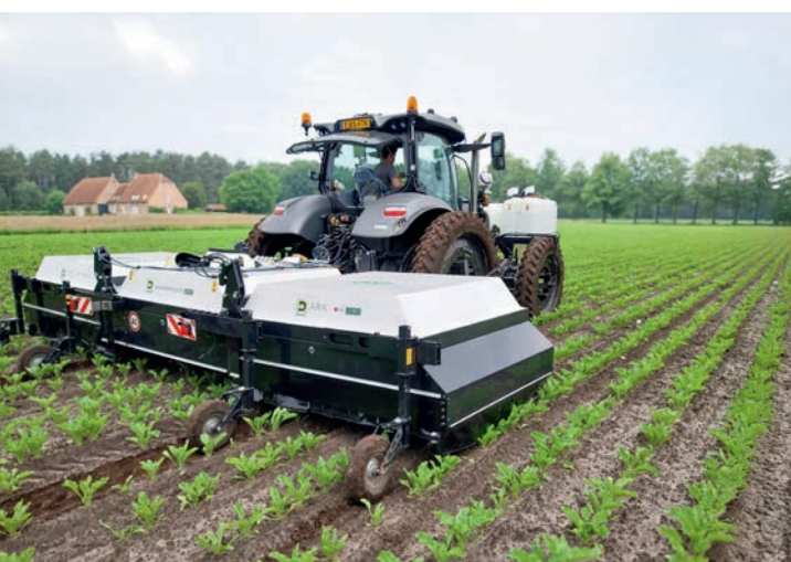
Plaatsspecifieke toepassing met ARA Ecorobotix spotsprayer.
