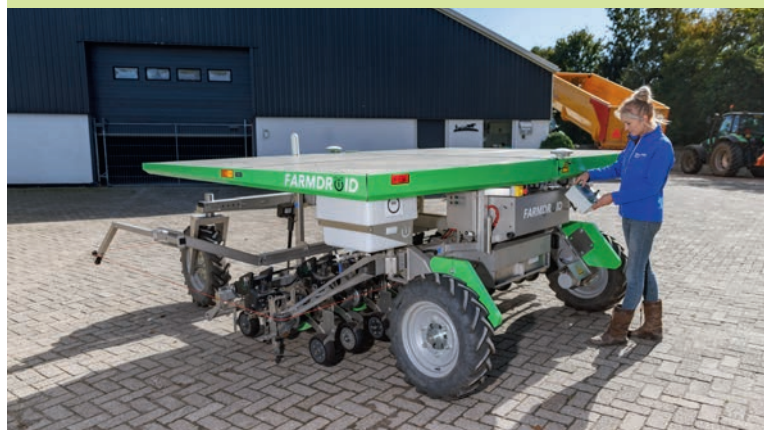
Mariëlle werkt met de Farmdroid, een autonome machine die op zonne-energie rijdt.
